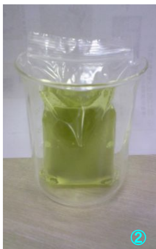
二酸化塩素溶液に対象金属を 浸漬する。
